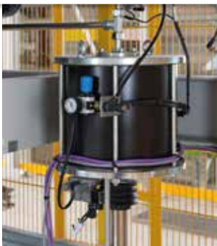
Bindemitteldosierung mit Balgdosiergerät BDG oder Zahnradpumpe mit Durchflussmesser Binder dosing with bellow dosing device BDG or geared pump with flow meter
