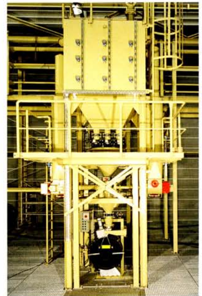
STATORMIX 123 mit Sand- und Additivwaage
