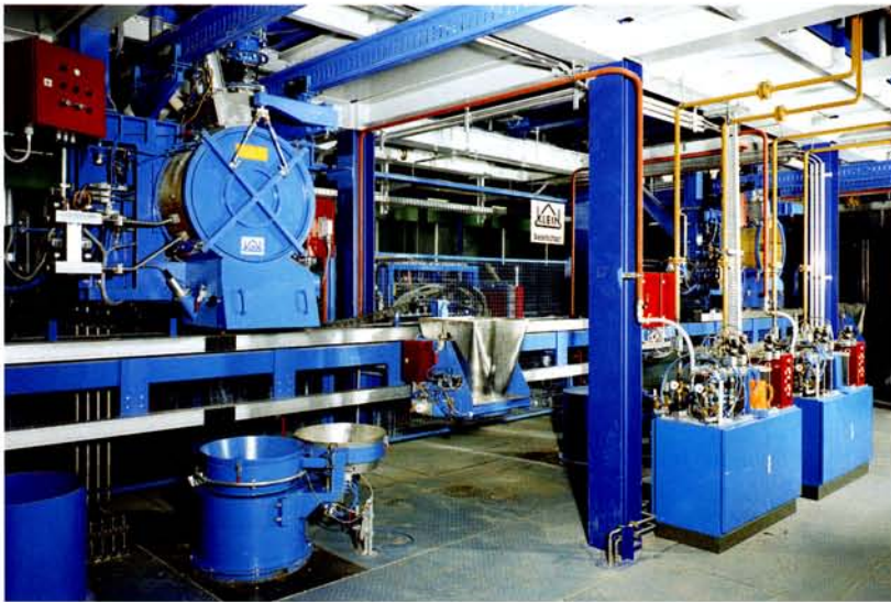
STATORMIX 122 mit Dosierstation und Verteilwagen
