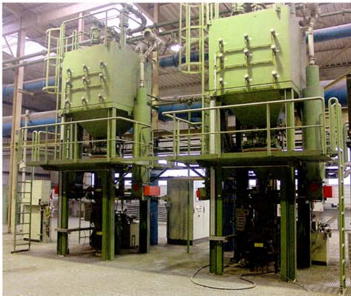
2 STATORMIX 53 mit Sand- und Additivwaage
