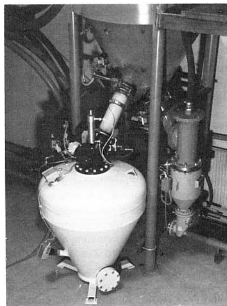
Bild 4. Versuchsanlage mit dem neuen Förderer (rechts), dem herkömmlichen Schubsender, Förderleitungsstrang und Empfangssilo
