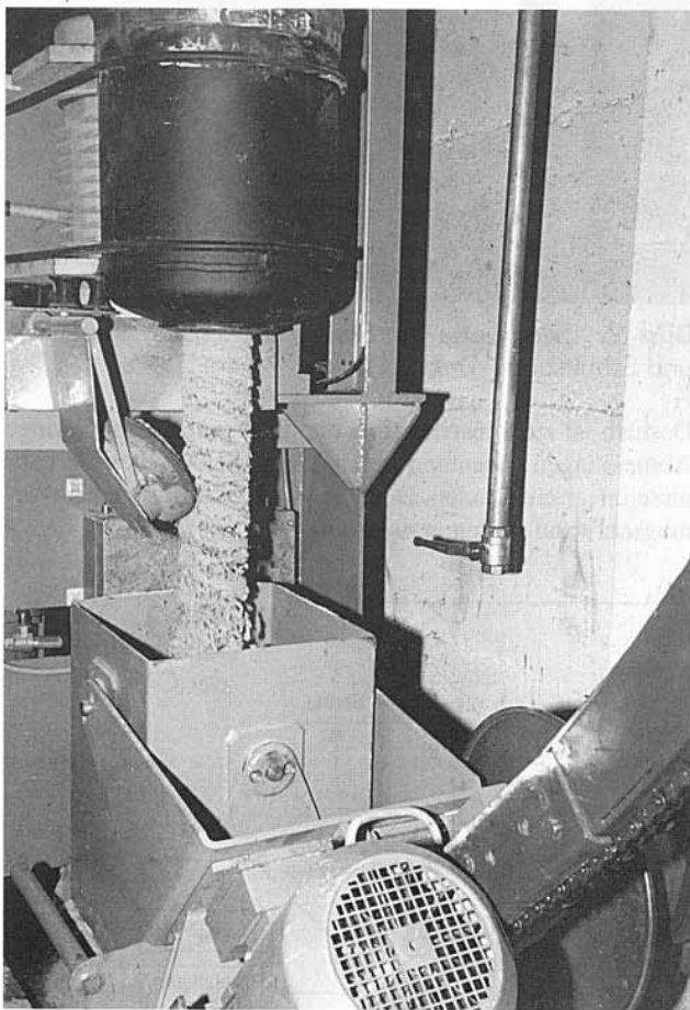
Bild 3. Kardanisch aufgehängter Transportwagen für gemischten Kernsand unter einem Schwingmischer (Werkbild KLEIN)
